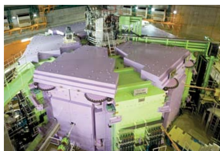
4. ábra. Szupravezető gyűrűs ciklotron a Riken Nishina Centerben, Wakóban ( https://www.nishina.riken.jp/facility/SRC_e.html )
