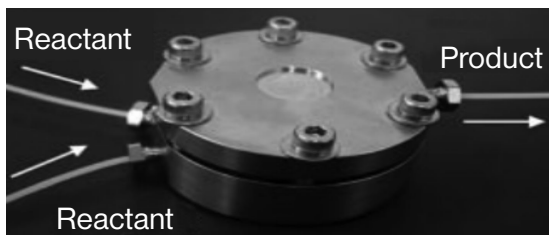
7. ábra. Egy mikroreaktor a 6. ábrán látható készülékből [4]
