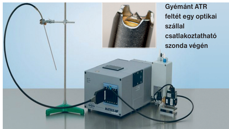
8. ábra. Bruker MATRIX-MF FT-IR spektroszkóp optikai szállal csatlakozó atr szondával [6]
