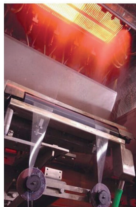
1. ábra. Az üvegszál előállítása
