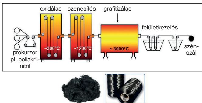
7. ábra. A szénszál előállítás
