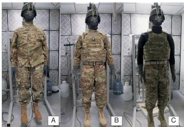
14. ábra. Különböző testpáncéllal ellátott védőöltözetek ruházatfiziológiai vizsgálata szenzoros bábun
