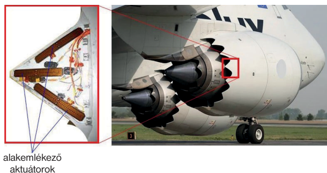
5. ábra. Változó geometriájú borítódíom – részben belülről – a sugárhajtómű hátsó részén
