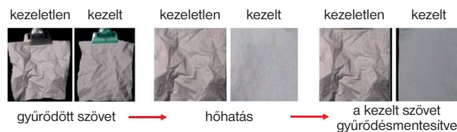
8. ábra. Pamutszövet gyűrődésmentesítése funkcionálisított hidrogélel
