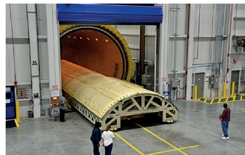
15. ábra. Prepregből történő kompozitalkatrész gyártásának elve
