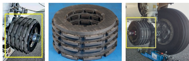
12. ábra. Szén-szén kompozittárcsák a repülőgépkerék-fékben
